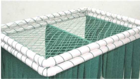
图1 试验所用浮床实物图
