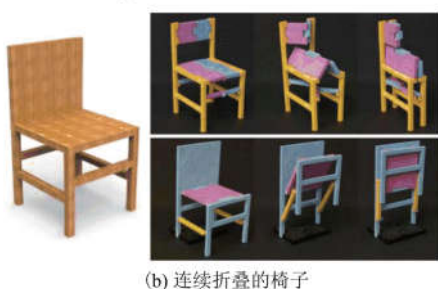
图 21 可折叠的家具机构设计 [46]
