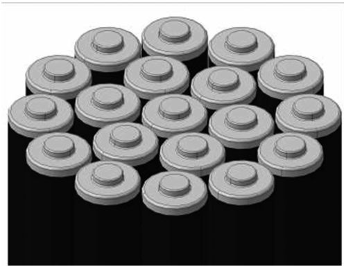
图 3 吸收体棒束头部结构
