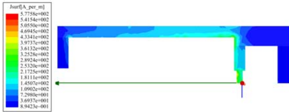
图 3 天线结构上电流分布
