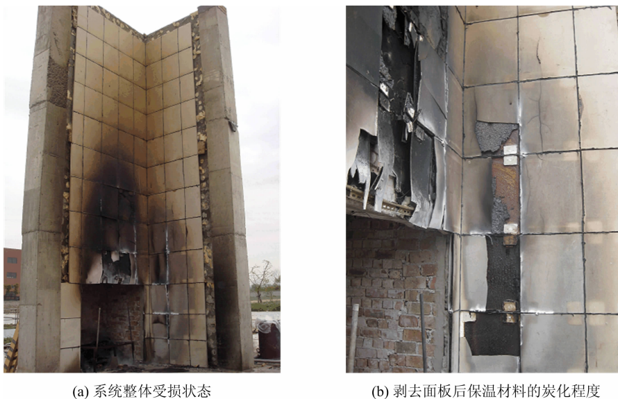
图 11 水泥纤维聚氨酯复合板保温系统的损坏状态
