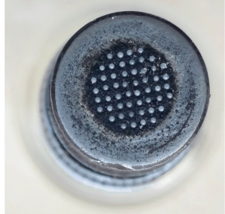
图 4 弥散型核燃料芯块初胚中的一个单层光学图像
