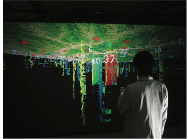
图 5 数字化测井数据从对应的井口位置悬挂着显示在路易斯安那州北部部分地区的 SRTM(Shuttle radar topography mission) 地图下 [19] .
